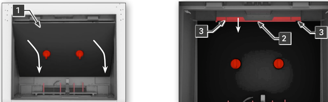
Fig.6: Installation du panneau réfléchissant arrière
