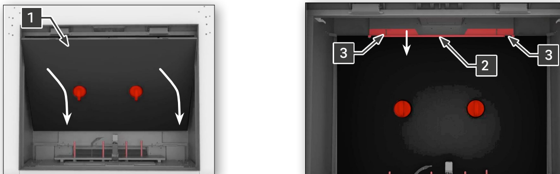
Fig.6: Installation du panneau réfléchissant arrière
